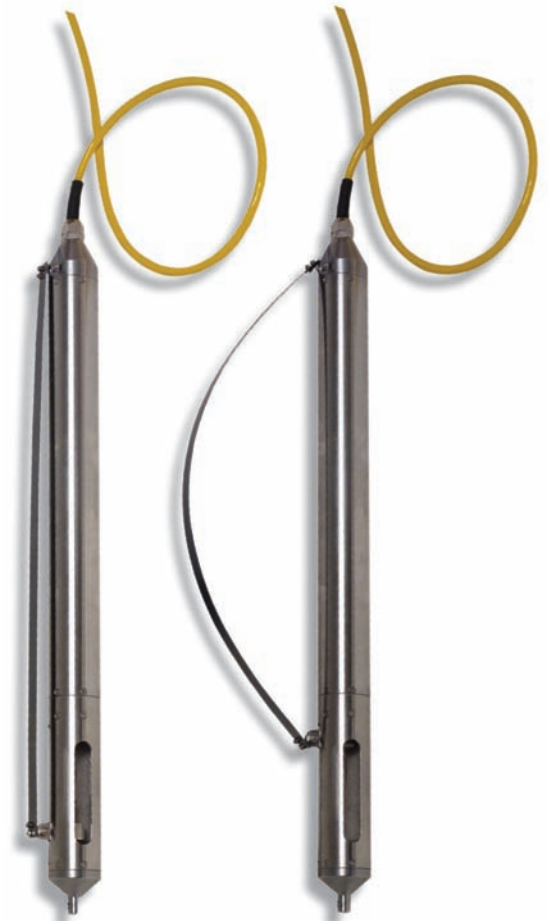
Meccanismo di adesione del DHTG alle pareti del foro ("clamping")
